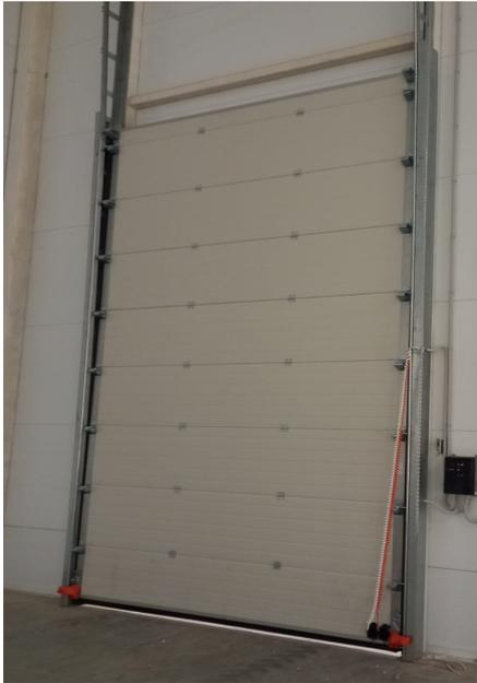
Рельсы, профили, соединяющие элементы, шарниры, опоры роликов и пластины подшипников полностью оцинкованы. Рельсы, также как и остальные фиксируемые соединения, крепятся на крепкие профили толщиной 2 мм посредством вдавливания. Таким образом, можно предотвратить деформацию и образование ржавчины вокруг соединений.
