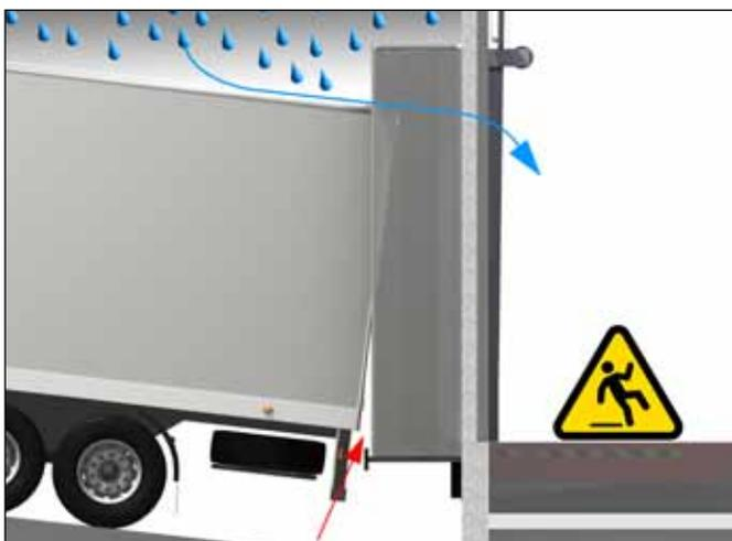
Если машины, заезжающие на погрузочно-разгрузочную площадку, оборудованы мультилифтом, мы рекомендуем, чтобы передняя сторона погрузочно-разгрузочной площадки была сделана так, чтобы мультилифт располагался ниже доквеллера. Тогда при заезде машины на погрузочно-разгрузочную площадку мультилифт безопасно располагается в кармане под доквеллером, и предотвращается повреждение машины или передней части погрузочно-разгрузочной рампы.
